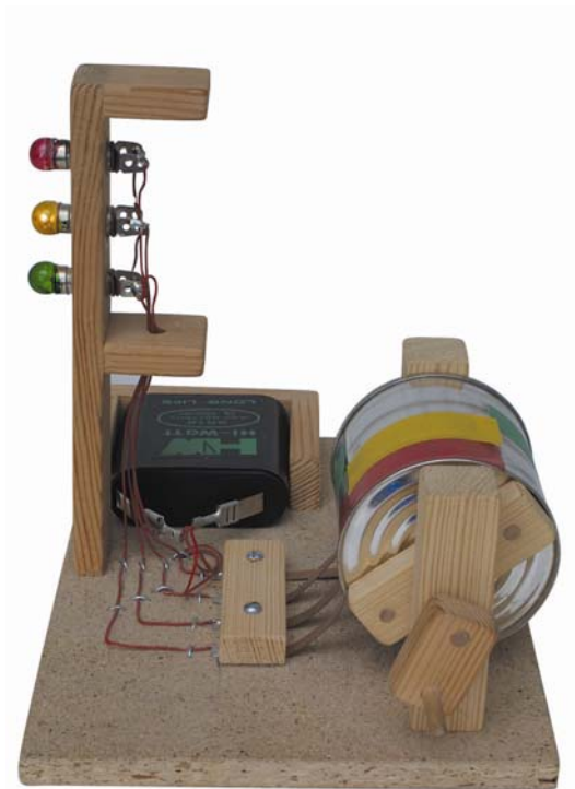
Figuur: Verkeerslicht met tijdschakelaar (Bron: opitec.nl)
