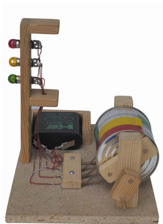
Figuur: Verkeerslicht met tijdschakelaar (Bron: opitec.nl)
